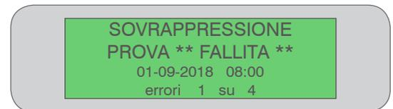
**ATTENZIONE:** *in fase di manutenzione è consigliato, durante la programmazione della successiva da PLC, di impostarla non a sei mesi da quella corrente (come previsto da Normativa) bensì a sette mesi di distanza da quella in corso. Questo perchè il PLC potrebbe riportare il segnale di manutenzione non effettuata anche in caso venga rispettata la scadenza.*
